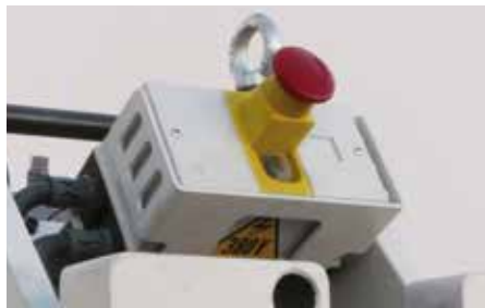
Boîte électrique avec bobine et protection moteur. Schaltkasten mit Spule und Motorschutz.
