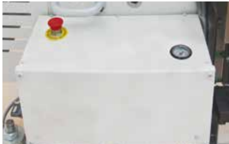
Boîte électrique-pneumatique. Elektrisch-pneumatischer Schaltkasten.
