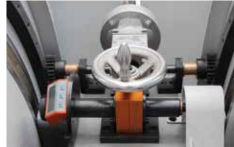
Affichage électronique de la pénétration de l'outil. Elektronisches Display zur Kontrolle der Fräsenpenetration.
