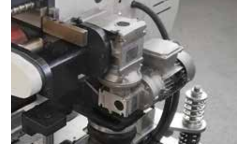
Réducteur de système de traction. Traktionssystem-Reduzierer.
